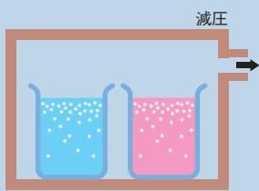
所定量の注型樹脂を、減圧脱泡します。
