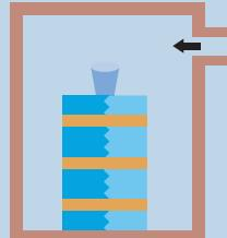
空気圧を戻すと、樹脂は型内に流れ込みます。所定の条件で樹脂を硬化させます。
