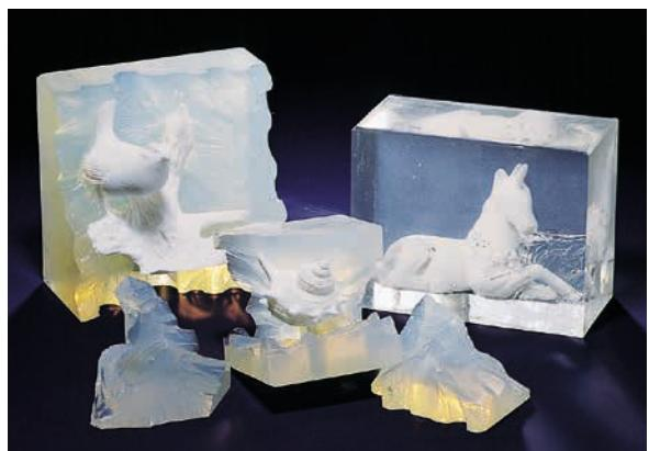
透明、半透明のRTVシリコーンゴムによる型取り
