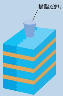
型を合わせ、テープや締め金具などでしっかりと固定し、樹脂だまりをゲート部に取り付けます。
