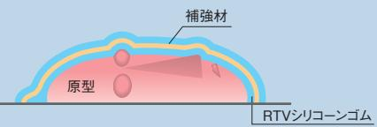
RTVシリコーンゴムの表面が硬化して、多少ベタつきがあるうちに補強材(ガラスコロス、ガーゼなど)を置き、再度RTVシリコーンゴムを2~3回重ね塗りします。
