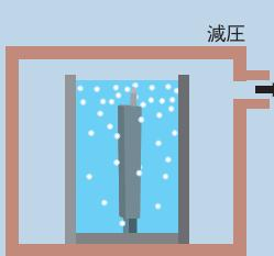
減圧脱泡し、所定時間放置して硬化させます。付加型の場合は、加熱すると硬化時間が短縮されます。
