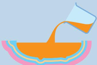
裏打ち材が完全に硬化した後、原型を取り出します。シリコーンゴム母型に注型樹脂を注入し、硬化させます。
