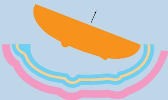
複製用の樹脂が硬化して、型から外すと複製品の完成です。
