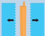
硬化した型を割り、注型品を取り出します。ゲートを切断し、ヤスリなどで仕上げます。
