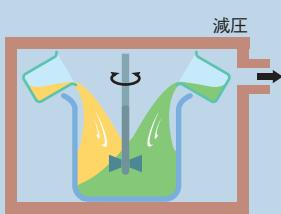
主剤と硬化剤を、減圧脱泡しながら、十分に混合します。
