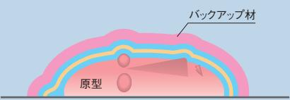
RTVシリコーンゴムが完全に硬化したら、石こうやポリエスチルなどの裏打ち材(バックアップ材)を塗り、型の強度を高めます。
