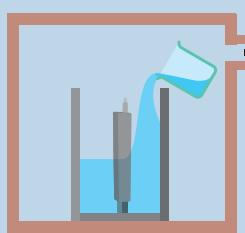
原型が完全に埋まるまでRTVシリコーンゴムを注入します。
