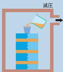
減圧下で、混合した注型樹脂を樹脂だまりから型に注入します。
