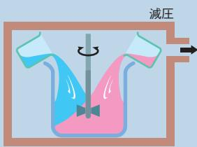
脱泡した注型樹脂を混合します。
