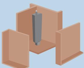
ゲートを型枠に接着させ、型枠を組み立てます。
