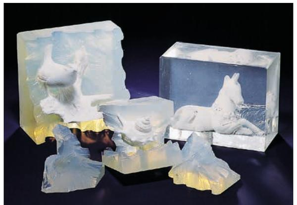
透明、半透明のRTVシリコンゴムによる型取り
