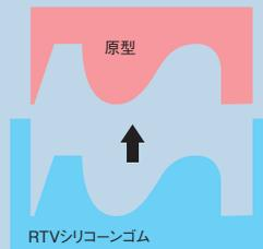
硬化完了後、枠原型を取り出すと、シリコンゴム母型が完成します。
