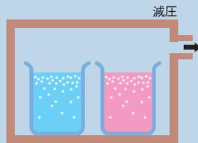
所定量の注型樹脂を、減圧脱泡します。
