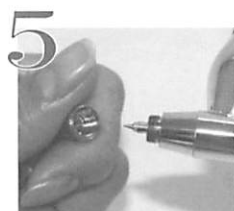
5 ノズルキャップを外します。
