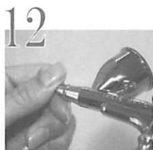
12 ニードルキャップ・ノズルキャップを取付けます。
