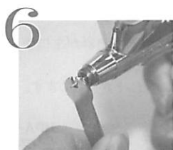
6 ノズルを専用スパナで取外します。
