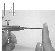
14 指でニードルが止るとことまで、ゆっくり押します。強く押し込むと、ノズルの破損の原因になります。
