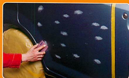
トレカットをトレカードに貼り付けてのゴミ取り作業
