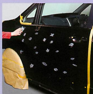
トレカットシートによるゴミ取り作業
