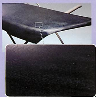
トレカットシートで研磨面を軽く研磨してゴミ探しをした状態
