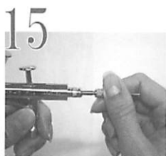
15 ニードル止めネジをしっかり締めます。
