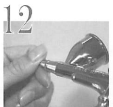
12 ニードルキャップ・ノズルキャップを取付けます。
