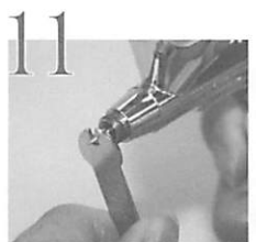
11 専用のスパナでノズルを取付けます。
