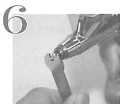
6 ノズルを専用スパナで取外します。
