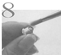
8 外したノズルキャップ・ニードルキャップも洗浄します。
